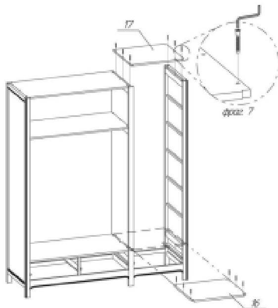
10 На готовую конструкцию установить на полочках лозы дощатки и параллельно для лоза 11 и крону лоза 13. Дорегулировать их впритык (см. фото 7) и скрепить согласно пункту 7.
