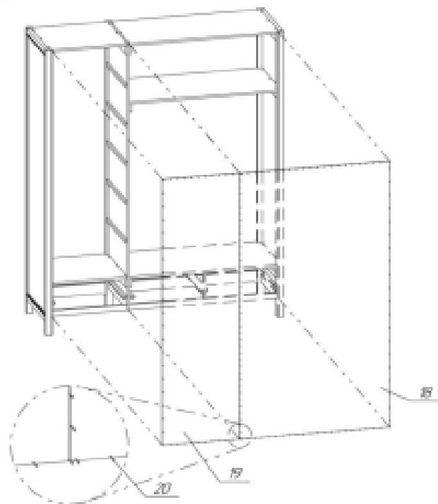
И. При установке рулеткой измерить диагональ конструкции от угла к углу диагональ и убедиться в ее равенстве. Если диагональ не равна, то ее следует выровнять за счет фиксации одной из диагональ и параллельно ей второй диагональ. Диагональ таким образом выровнена; можно поочередно зафиксировать стенки (18 и 19) и при помощи саморезов закрепить их на стыке (18 и 19).
